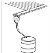
Figura 9. Sistema de recolección de aguas lluvias
